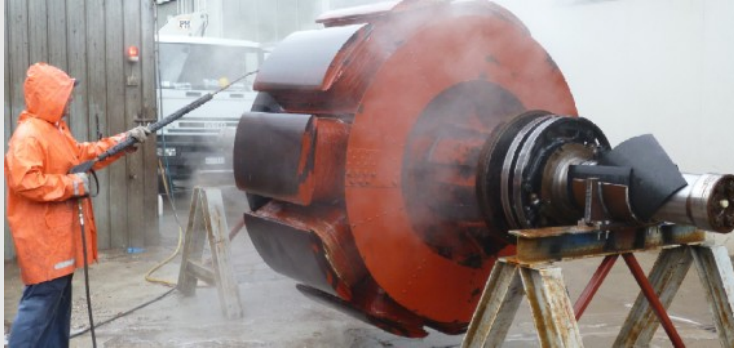
Revisione alternatore idroelettrico
