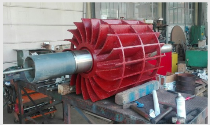
Revisione pompa del vuoto
